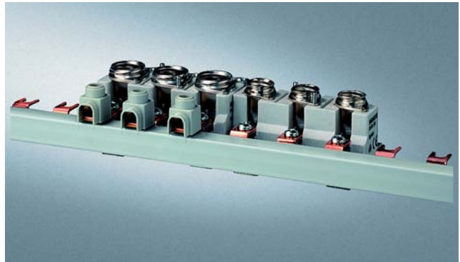
Base portafusibles tripolar D01 y D02 Versiones de bornes B y K Barra 5SH5 320 Borne de conexión 5SH5 328 Tapas terminales 5SH5 514
